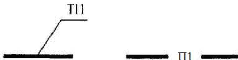
Рисунок 6 Буквенно-цифровое обозначение трубопроводов или воздуховодов
